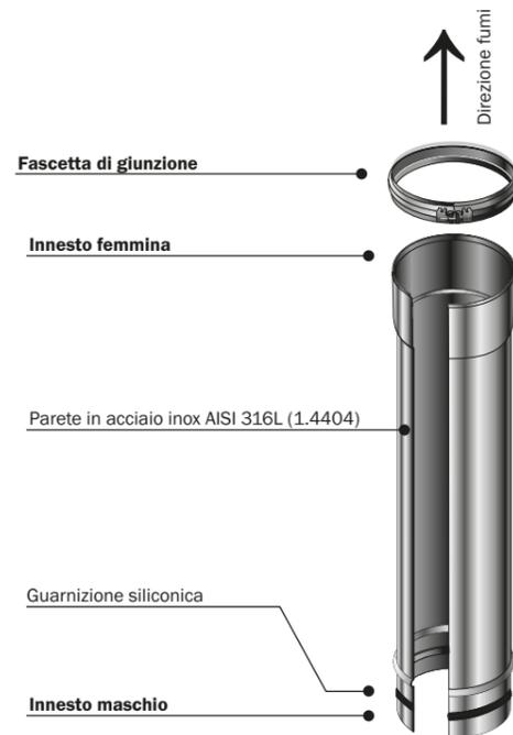
Nota: la guarnizione è applicata sull'innesto maschio per i diametri Ø 160-250-300-350-400 mm
