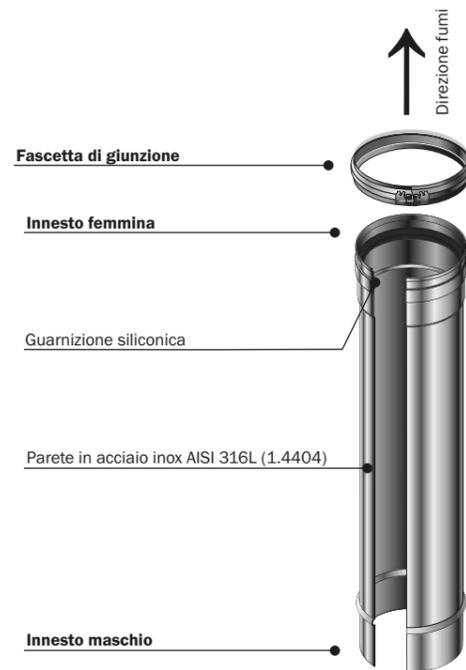
Nota: la guarnizione è applicata sull'innesto femmina per i diametri Ø 60-80-100-120-130-140-150-180-200 mm
