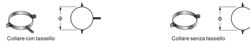
**Collare di fissaggio** Permette lo staffaggio del condotto fumario.
